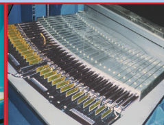
Oben: Integriertes Tomographie-System (ITS) mit Detailaufnahmen verschiedener Beladungen (200-L-Fässer, verlorene Betonabschirmung (VBA), Betonriegel) Links: ^{60}\text{Co} -Quelle in Abschirmbehälter und 30-Detektor-System
